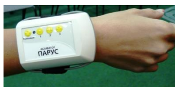
Индивидуальное устройство для приведения маяка в действие
